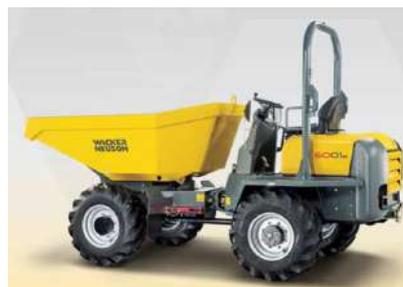
DUMPER USA DESCARGA HIDRAULICA GIRATORIA 4X4
