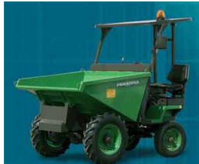
DUMPER PIQUERSA DESCARGA ALTURA
