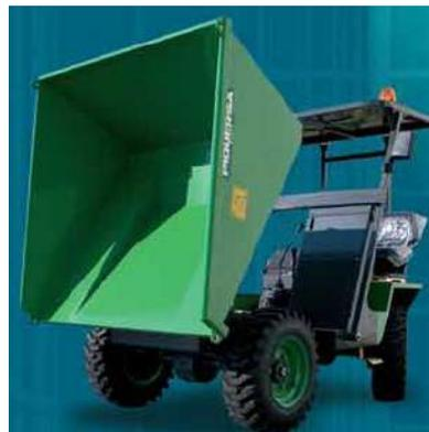
DUMPER PIQUERSA DESCARGA HID. GIRATORIA 4X4
