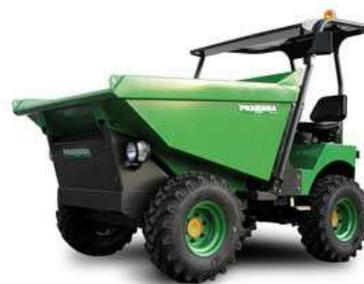
DUMPER WACKER DESCARGA HIDRAULICA GIRATORIA
